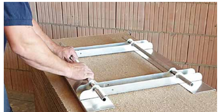
Transporthilfe für Lehmbauplatten
