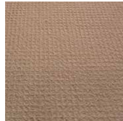
Glasgewebe 112 flächig in Lehmklebe- und Armiermörtel eingearbeitet
